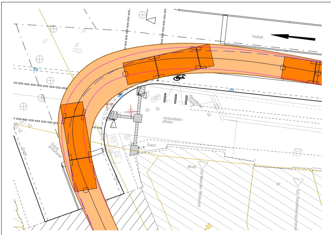
Abb. 4: Schleppkurvennachweis Einmündung Engelsgrube / An der Untertrave
