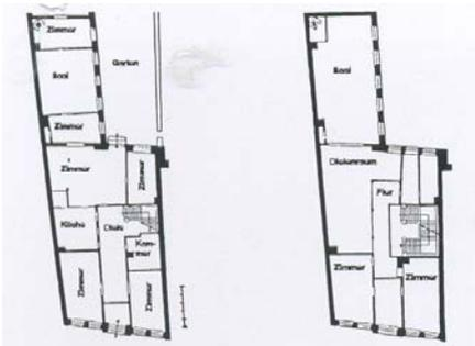
Der Originalgrundriss des Erdgeschosses (links). Der Grundriss des ersten Obergeschosses wurde im 19. Jh. verändert.
