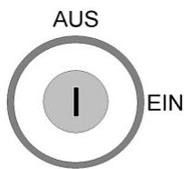
EIN-/AUS-Taster, Schlüsselform „MS12“, zum Ein- bzw. Ausschalten der Fahrwegstelltafeln und Bedientafeln
