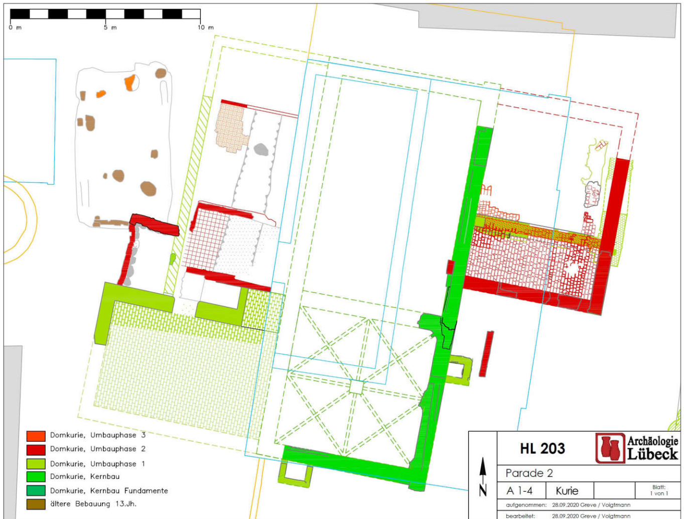
Abb. 25 Kernbau der Domkurie mit Anbauten der Umbauphasen nach Westen und Osten. Stand der Interpretation nach dem 2. BA.
