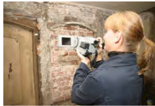
09.18 Messung mit der Wärmebildkamera
