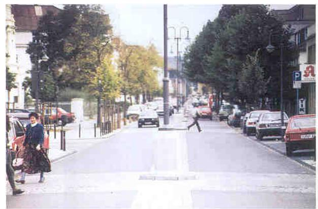
Durchgehende Mittelstreifen, wie in diesem Beispiel aus Hennef, bieten dem Fußgänger auf längeren Straßenabschnitten Hilfen bei der Fahrbahnüberquerung.
