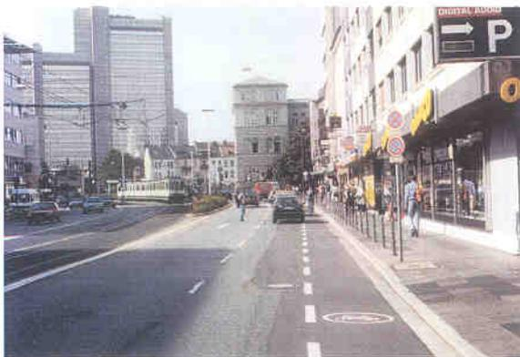
Anlage von Schutzstreifen, wie in diesem Beispiel aus Bonn, sind bei beengten Verhältnissen ein geeigneter Schutz der Radfahrer.
