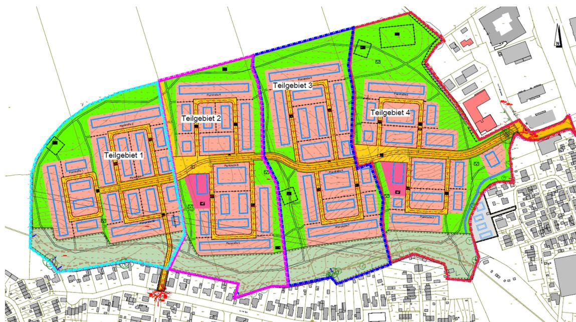
**Abbildung 16: Teileinzugsgebiete Entwässerung (Büro IPP auf Grundlage B-Plan-Entwurf)**
