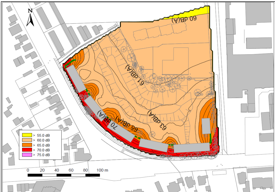
Abbildung 4: maßgeblicher Außenlärmpegel für schutzbedürftige Räume
