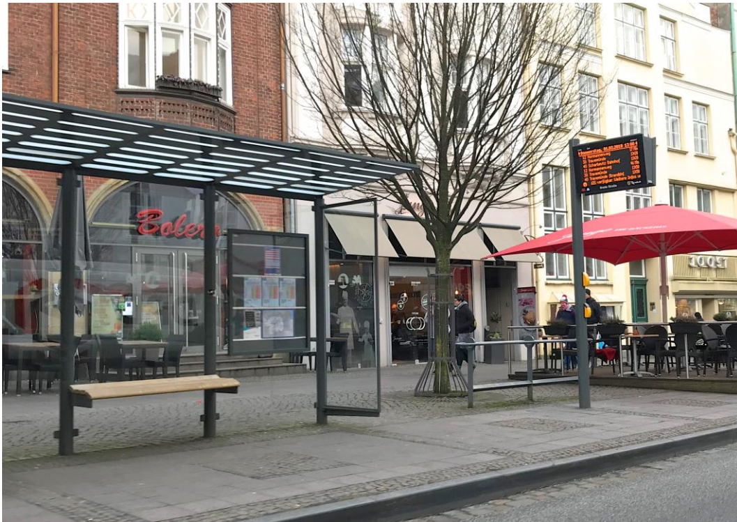
Abbildung 19: Haltestelle mit DFI-Anlage und Außenansage für Sehbehinderte
